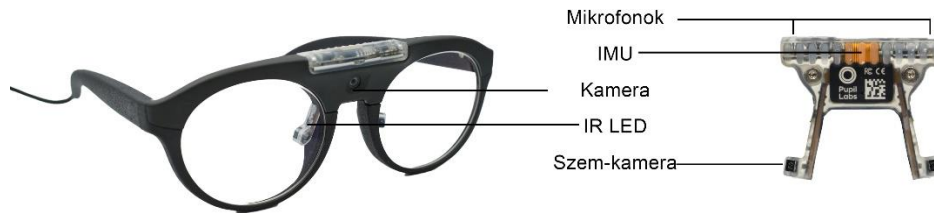
5. Ábra Pupil Labs Neon szemmozgás követő rendszer (forrás: Mit látsz? És mire figyelsz valójában? Dr. Nagy Viktor Zoltán előadása)
